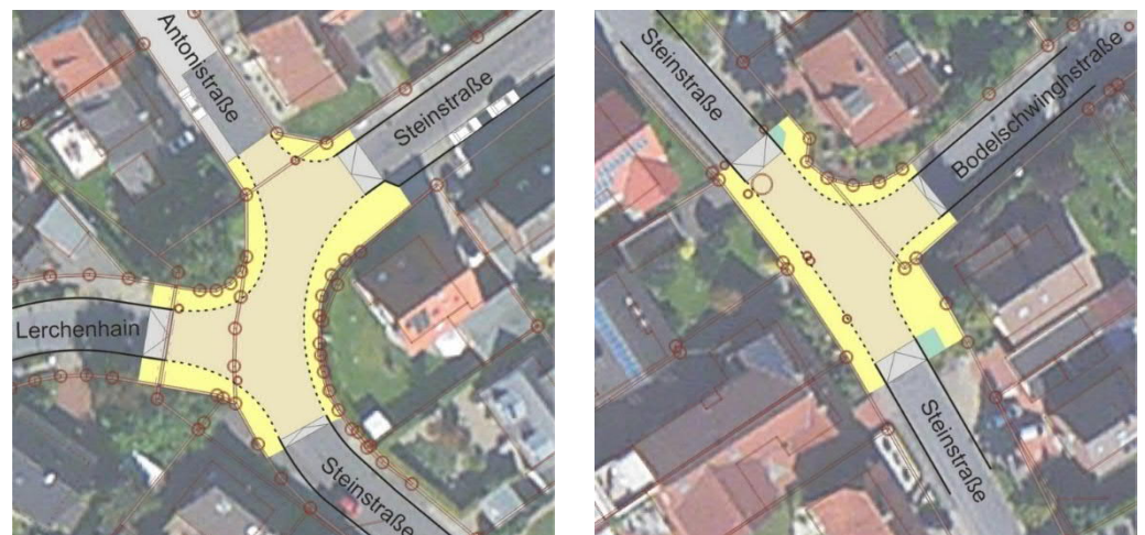
Abb. 17 Entwurfsskizze für eine Teilaufpflasterung in Knotenpunktbereichen (li. Steinstraße/Lerchenhain/Antonistraße, re. Steinstraße/Bodelschwinghstraße)
