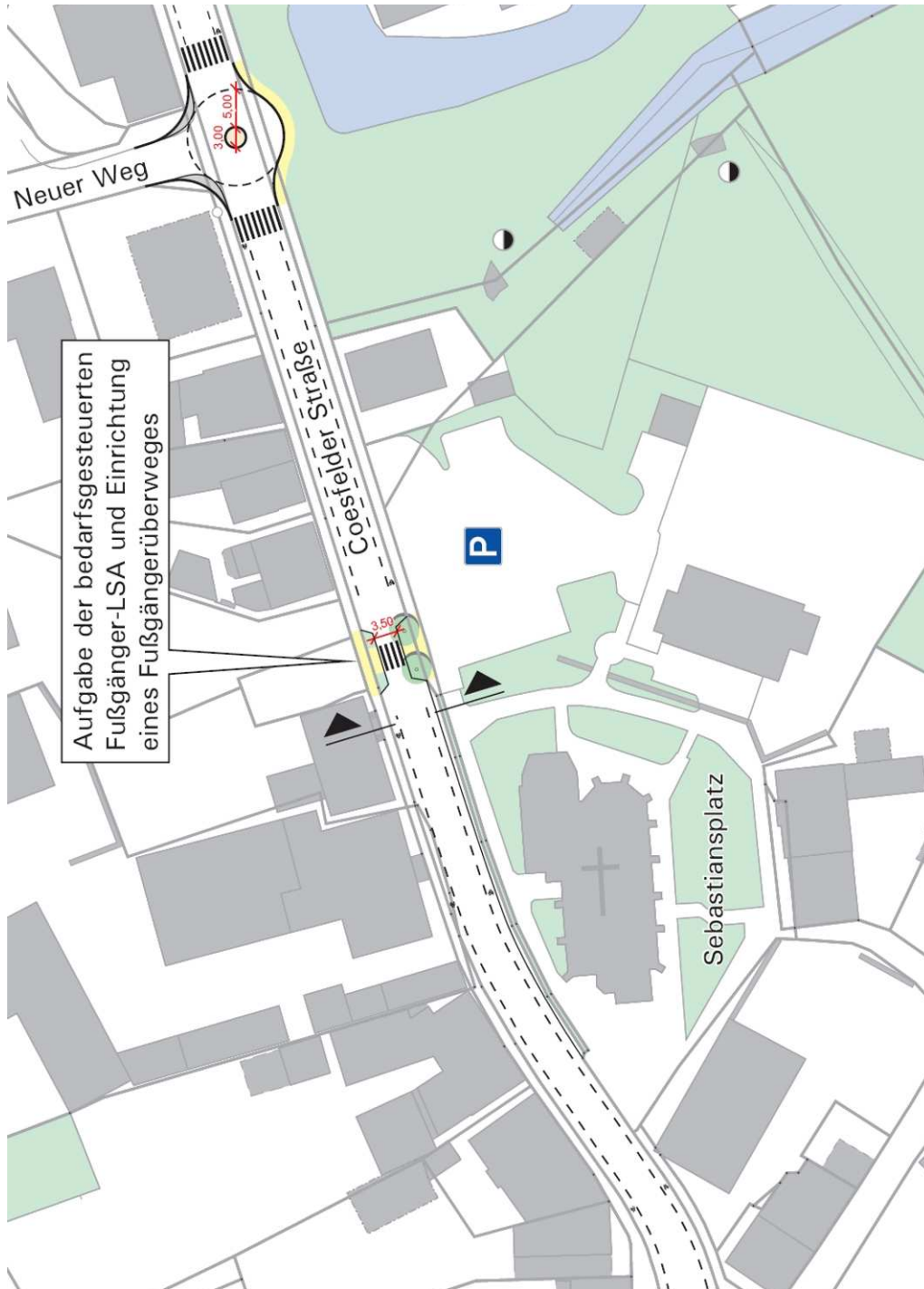
Abb. 77 Umgestaltung der Ortsdurchfahrt gemäß Querschnittvariante 1, Minikreisverkehr am Knotenpunkt Coesfelder Straße Neuer Weg
